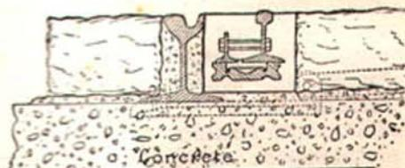
387. Подземный проводъ для электрическихъ трамваевъ системы Линева.
