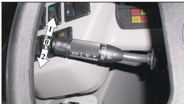
Рисунок 2.9 – Включение указателей поворота
