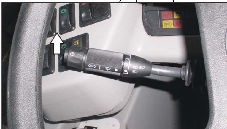
Рисунок 2.8 - Включение ближнего/дальнего света фар.
